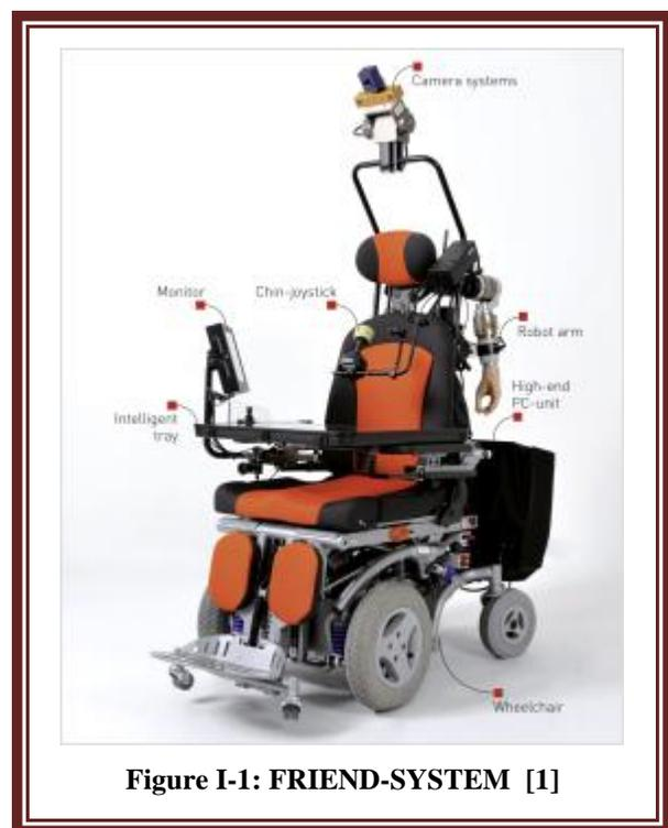
FRIEND-System, welches in der Abbildung 1 bezeichnet wird, besteht aus einem elektrischen Rollstuhl mit den Roboterarm MANUS.
